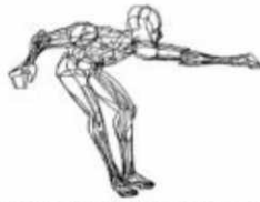
Vom Computer gesteuerte menschliche Figur für ergonomische Simulation. Die als Programm eingeführte Stellung kann auf Wunsch vom Computer von jedem beliebigen Blickpunkt und jeder Entfernung gesehnet werden.
